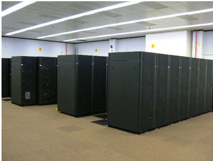
Figuur 7. Eén van de twee IBM Power5+ Cluster 1600 systemen van het ECMWF
