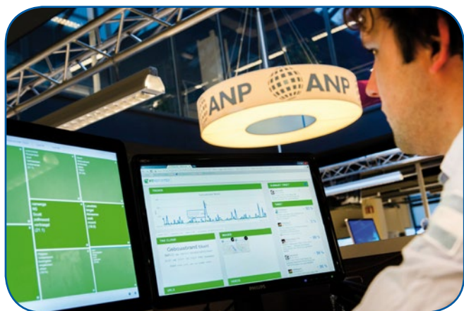
RTreporter in gebruik bij het ANP, het linkerscherm toont een top-10 van gedetecteerde onderwerpen, het rechterscherm toont de grootte van een geselecteerd cluster als functie van de tijd
